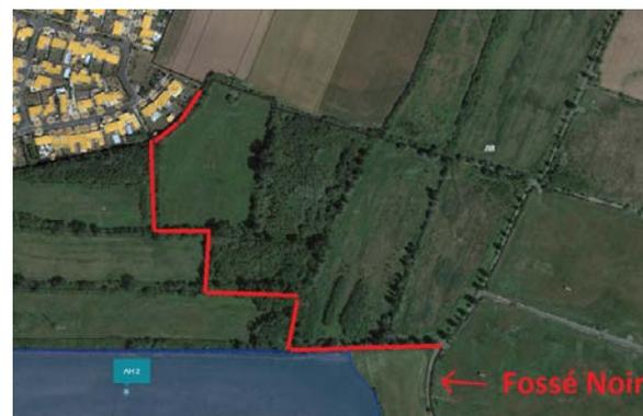
Nous avons attendu le **curage de ce fossé** effectué par le Syndicat des Marais pour étudier les travaux à effectuer pour optimiser l'évacuation de notre réseau pluvial. Un choix de remise en état des fossés tertiaires a nécessité un **chantier important d'élagage et de curage** des fossés sur une longueur de 665.00 ml. Ces travaux ont été pris en charge par les propriétaires riverains et la mairie.
